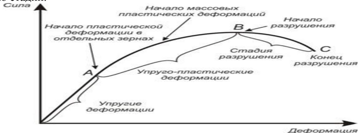
Рис. 1 Схема процесса деформации
