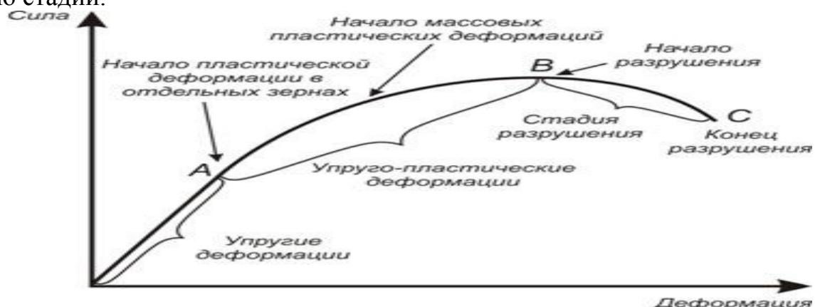
Рис. 1 Схема процесса деформации
